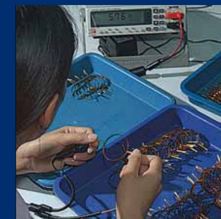
Überprüfung der Schwingspule des Kompressionstreibers.
