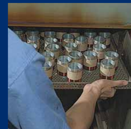
Frisch aus dem Ofen: „Selbstgebackene“ Schwingspulen.
