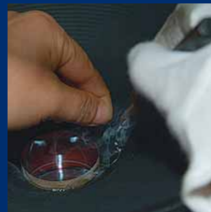
Befestigung der Schwingspule/Spinne bei einem 10" Tieftöner.
